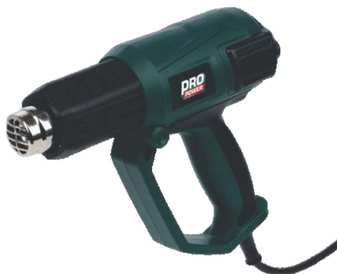
3 TREPTE DE ÎNCĂLZIRE: I: 50°C / II: 450°C / III: 600°C
