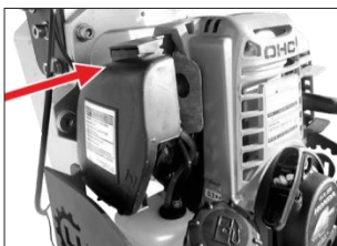
Demontarea capacului filtrului
