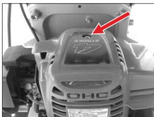
Demontare capac superior
