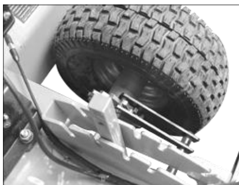
Blocarea rotorului la setările de adâncime de la 1 la 3 (minime-maxime).
