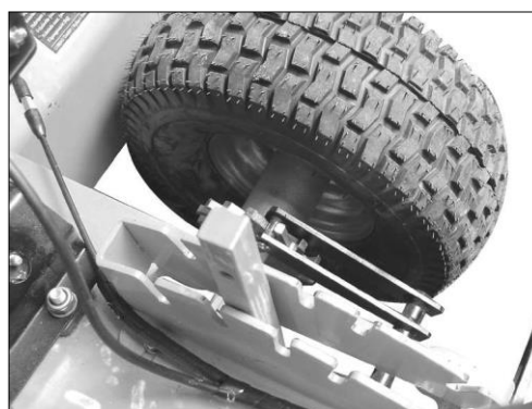
Blocarea rotorului la setările de adâncime de la 1 la 4 (minime-maxime).
